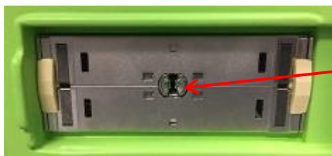
20 pav. Užrakto skylutė keitiklio jungties lizde
