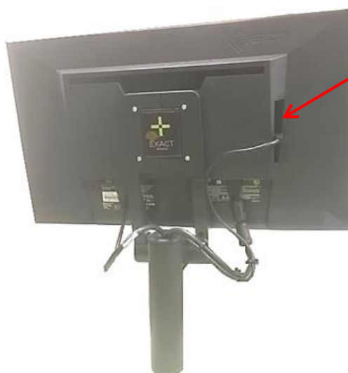
8 pav. Monitoriaus galinėje dalyje esančios USB jungtys (yra kai kuriose ExactVu sistemos konfigūracijose)
